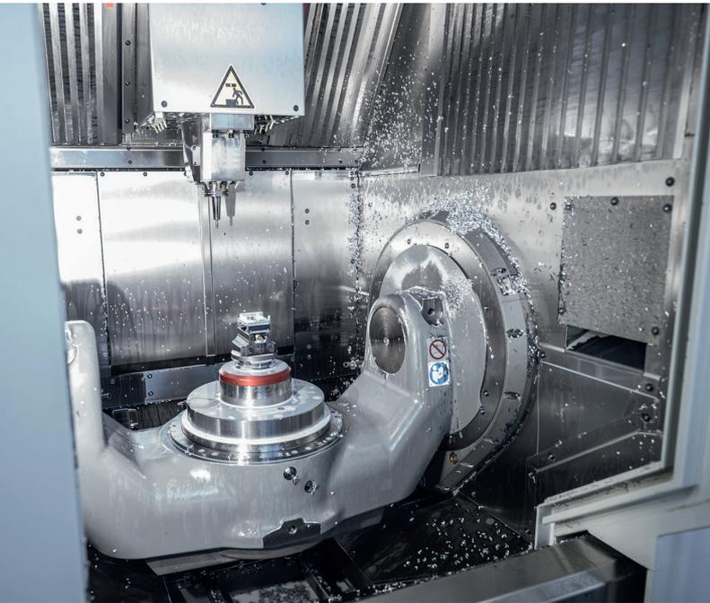
4 Zwischen einer Minute und 1,5 Stunden lang bearbeitet die C 12 U die Werkstücke © Hermle
